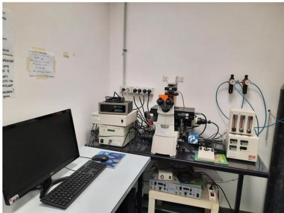
Microscopio a fluorescenza, con stage automatizzato per acquisizione di immagini seriali in XY e an z di preparati fissati, e con strumentazione Okolab per acquisizioni di immagini e video di cellule in coltura. Software MetaMorph.
