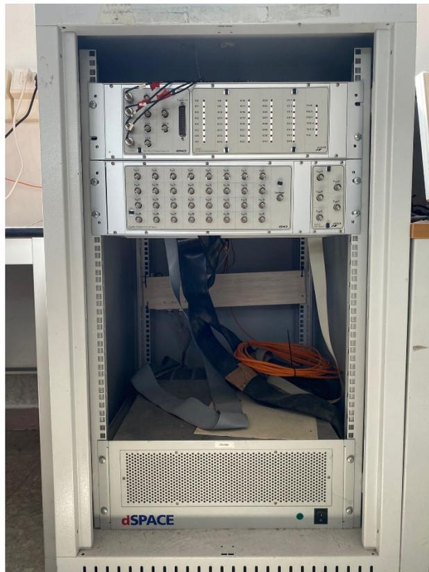
**Fig. 4.** (IT) Sistema dSpace per la simulazione HIL (EN) SdSpace system for HIT simulation
