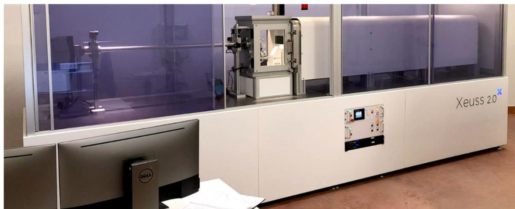
Fig.1: Il diffrattometro Xenocs Xeuss 2.0-Q-Xoom del SAXSLab Sapienza (stanza 058, edificio CU014)
